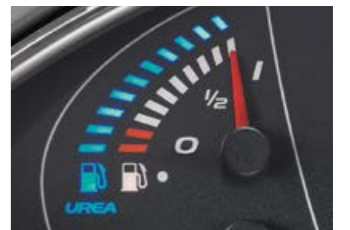
Affichage du niveau de remplissage du réservoir d'urée et de la jauge de carburant sur le tableau de bord.
