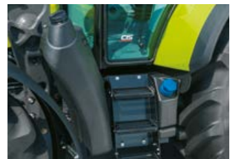
Tubulures de remplissage pour le réservoir d'urée de 17 l ou 22 l et le réservoir de carburant de 140 l ou 190 l du côté gauche.
