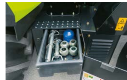
La batterie et la boîte à outils sont aisément accessibles à droite du marchepied d'accès à la cabine.
