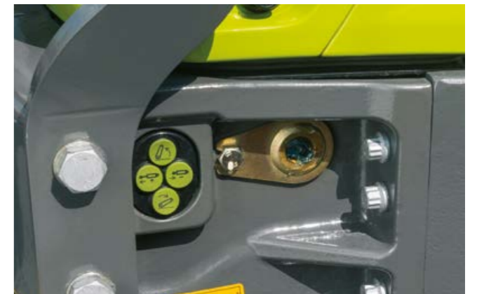
Le relevage avant et le distributeur supplémentaire peuvent également être commandés depuis l'extérieur via les distributeurs électro-hydrauliques.
