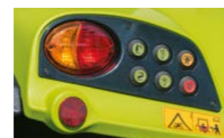
Commande possible d'un distributeur électro-hydraulique sur les deux ailes.
