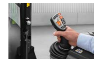
La commande des distributeurs électro-hydrauliques s'effectue via les commandes en ligne sur la console latérale et via l'ELECTROPILOT intégré au levier multifonctions.
