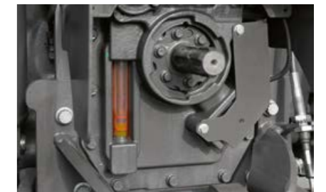
Contrôle aisé du niveau d'huile de transmission et d'huile hydraulique au moyen du regard à côté de la prise de force.
