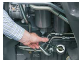
La jauge de niveau d'huile moteur est facile d'accès, même avec le chargeur frontal.
