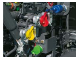
Il est également possible de combiner un freinage pneumatique de remorque avec un freinage hydraulique.
