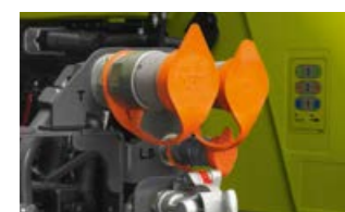
Les outils particulièrement gourmands en hydraulique sont alimentés par le circuit load sensing via les raccords « Power Beyond ».
