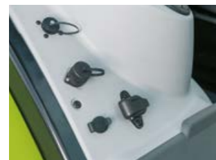
Connexions ISOBUS dans la cabine et à l'arrière.
