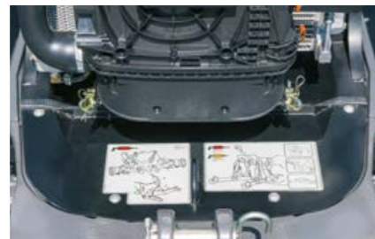
Un schéma de graissage est disponible sous le capot moteur pour faciliter la maintenance.
