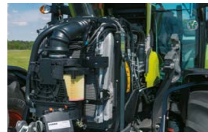
Retrait aisé du filtre à air moteur devant les radiateurs.
