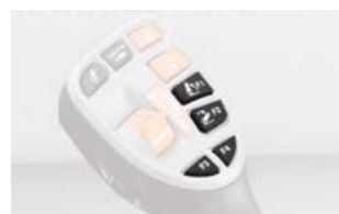
L'activation des séquences CSM est confortable via les touches de fonction du levier multifonctions.
