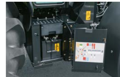
La batterie et la boîte à outils sont aisément accessibles à droite du marchepied d'accès à la cabine.
