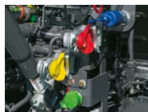
Luchtdrukremstelsysteem en hydraulische remmen kunnen ook worden gecombineerd.
