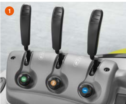
Ongeacht mechanisch of elektronisch, de regelventielen zijn in de zijconsole goed bereikbaar en comfortabel te bedienen.
