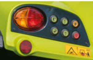
Bediening van een elektronisch regelventiel op beide spatborden mogelijk.
