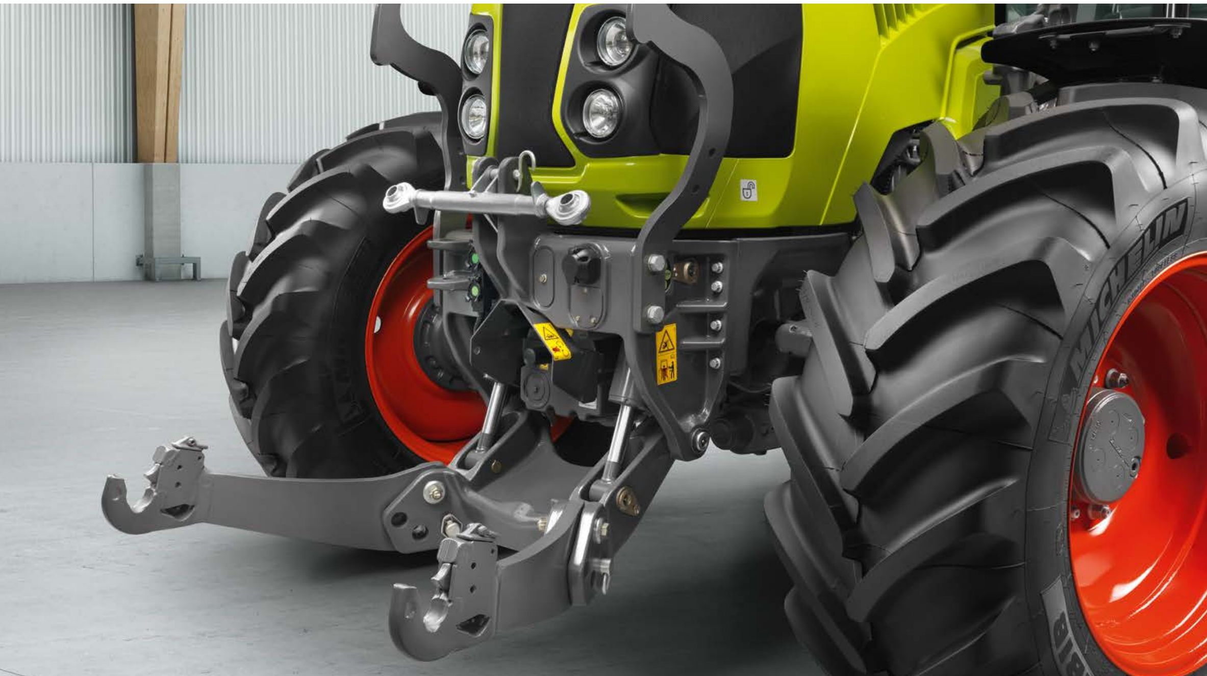
Voor alle toepassingen bruikbaar door de sterke fronthefinrichting.
