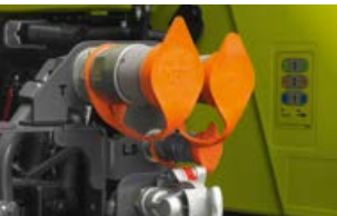
Hydraulisch veeleisende werktuigen worden aangestuurd met het Load-Sensing systeem via de Power-Beyond aansluitingen.
