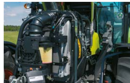
Eenvoudig wegnemen van het motorluchtfilter voor de koelerpakketten.
