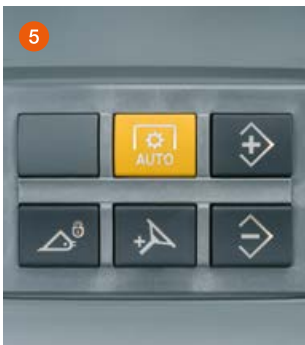
Bedieningspaneel extra functies: veiligheidsschakelaar, vergrendeling van de voorlader, activering aftakasautomaat, activering dynamische besturing, fijnafstelling van het motortoerentalgeheugen.
