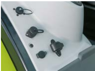
Aansluitingen voor ISOBUS in de cabine en aan de achterzijde.
