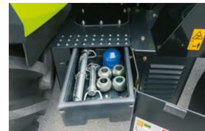
Aan de rechterkant in de opstap bevinden zich goed bereikbaar, de accu en een opbergvak voor gereedschap.
