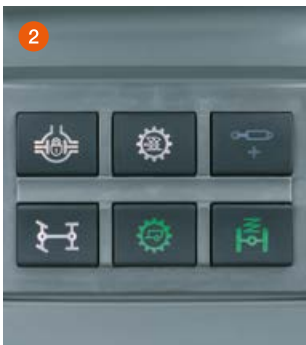
Bedieningspaneel hoofdfuncties: differentieelslot, vierwielaandrijving, weg- en achteruitrijmodus, hydraulische pompommering en activering van de voorasvering.
