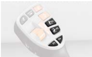
CSM sequenties worden comfortabel met de functietoetsen op de multifunctionele hendel geactiveerd.
