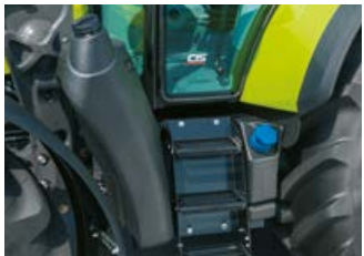
Vulopeningen voor 17 of 22 liter ureumoplossing en 140 of 190 liter brandstof bij de linker opstap.
