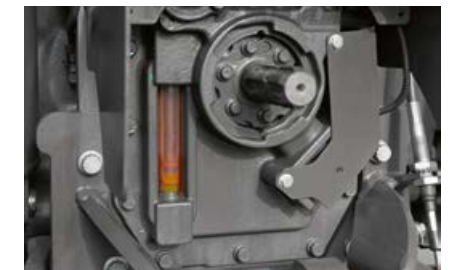
Eenvoudige controle van het oliepeil van transmissie en hydrauliek door het kijkglas naast de aftakas.
