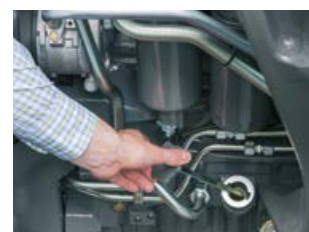
De peilstok voor de motorolie is met aangebouwde voorlader goed bereikbaar.
