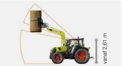
Cabine met verhoogd dak met glazen dakluik: doorrijhoogte vanaf 2,61 m.
