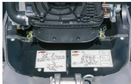
Onder de motorkap bevindt zich een smeerschema, die het onderhoud eenvoudiger maakt.
