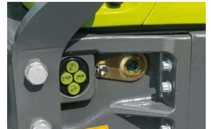
Met elektronische regelventielen kunnen de fronthef en het extra regelventiel ook extern worden bediend.
