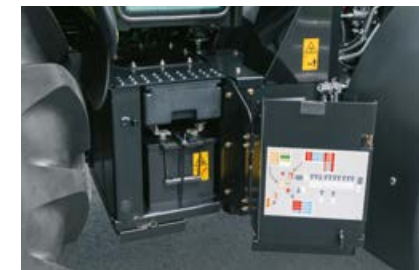
Aan de rechterkant in de opstap bevinden zich goed bereikbaar, de accu en een opbergvak voor gereedschap.
