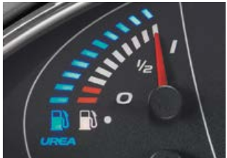
Weergave van de niveaus van ureumoplossing en brandstof op het dashboard.
