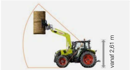
PANORAMIC cabine met voorruit tot glazen dat uit één stuk: doorrijhoogte vanaf 2,61 m.
