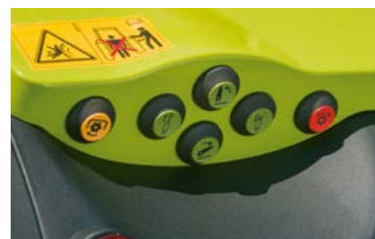
Externe bediening voor de achteraftakas op beide spatborden.
