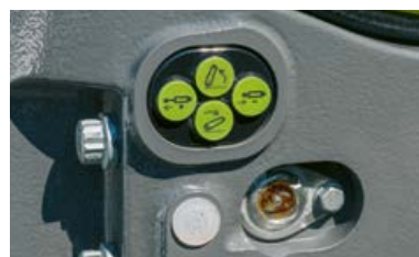
Externe bediening voor de fronthef en één regelventiel in de CEBIS-uitvoering.
