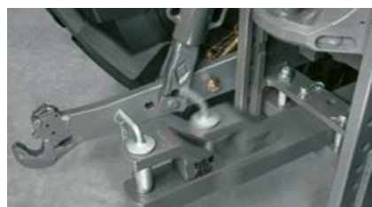
Er zijn verschillende posities voor de ondertrekken. De uitgeschoven positie verbetert de wendbaarheid.
