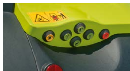
Externe bedieningselementen voor de achterhefinrichting, aftakas en één regelventiel (alleen met CEBIS vrij te kiezen)
