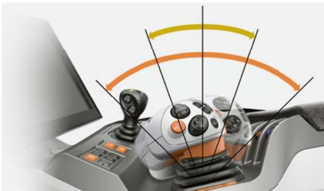
Schakelen van de powershifttrappen +/- Groepenschakeling +/-
