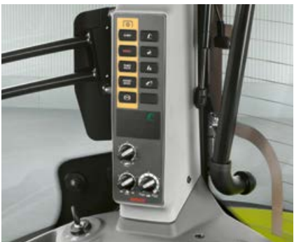
Aftakassnelheden en elektronisch geregelde hefinrichting op de B-stijl in te stellen.
