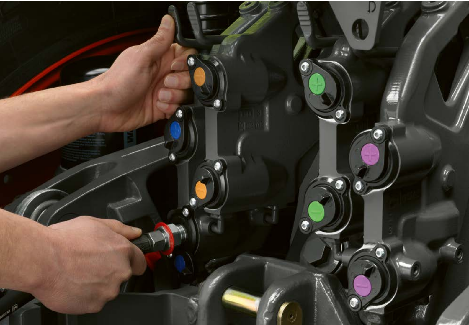
Aan de fronthef bevinden zich de aansluitingen voor een regelventiel en een vrije retour.
