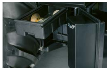
La batterie et la boîte à outils sont aisément accessibles à au niveau du marchepied droit.
