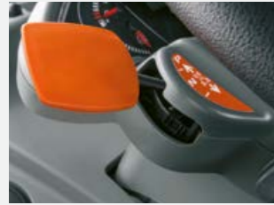
Inverseur sous charge REVERSHIFT avec frein à main électro-hydraulique
