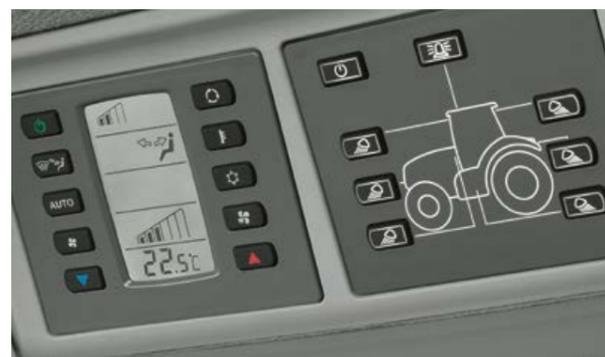
Une climatisation entièrement automatique est également disponible en plus de la commande manuelle de la climatisation. Elle assure une diffusion optimale du flux d'air dans la cabine.
