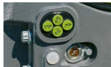
Commande extérieure du relevage avant et d'un distributeur sur la définition CEBIS.
