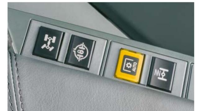
Activation de la suspension du pont avant.
